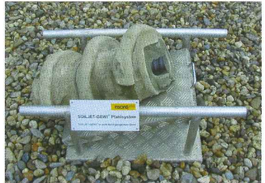
Auf dem Foto ist ein aus der Endtiefe gewonnenes Pfahlstück abgebildet.
