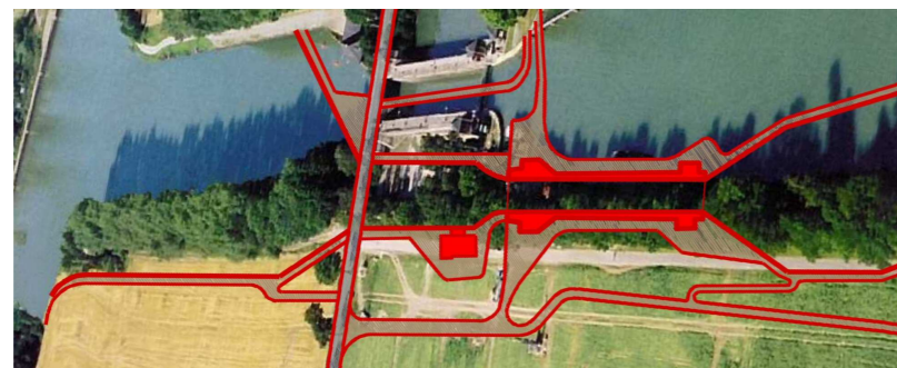
Luftbild der Schleusenanlage mit geplanter neuer Schleuse
