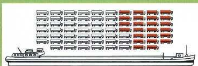
Fast 70 Lastzüge sind nötig, um ein modernes Europaschiff zu ersetzen. (Der Ladungsanteil, der im jetzigen Profil nicht transportiert werden kann, ist rot dargestellt.)
